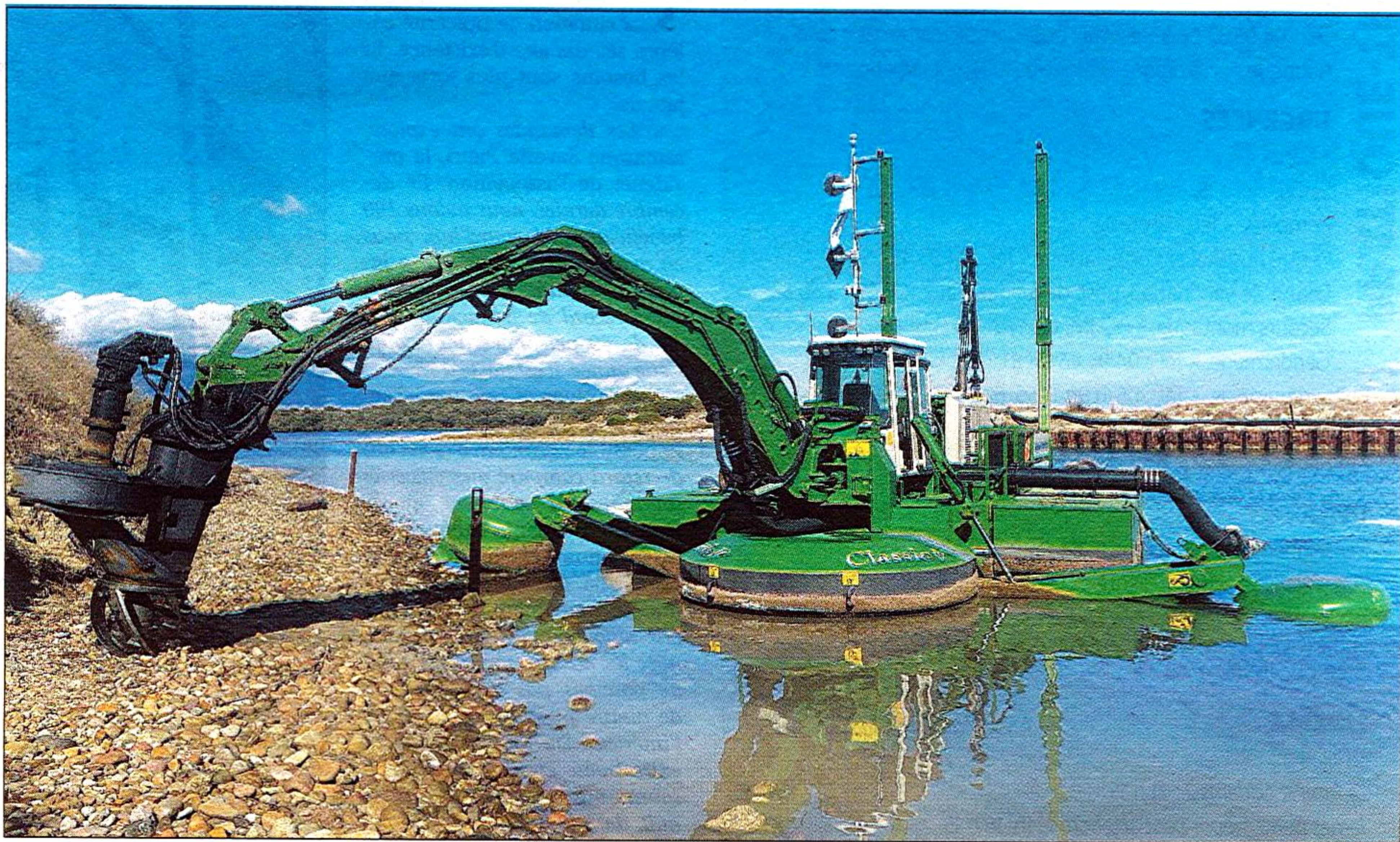
Grâce à ses « pattes » hydrauliques, l'engin se déplace au plus près des berges.
